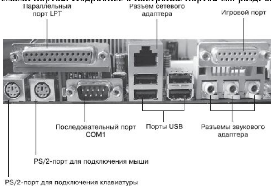
Рис. 1.4. Разъемы портов на задней панели системной платы
