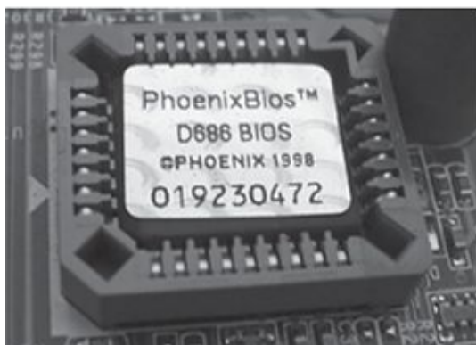
Рис. 2.1. Примеры установки микросхемы BIOS на панель системной платы
