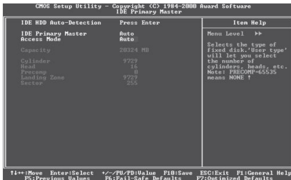
Рис. 4.4. Параметры жесткого диска, подключенного к каналу IDE Primary Master
